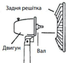
Встановіть задню решітку на вал двигуна і закріпіть за допомогою гайки для грат.
