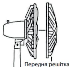
З'єднайте разом передню та задню решітки, закріпіть затискачами або загвинтіть кільце решітки.
