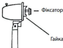
Відгвинтіть фіксатор, повернувши його за годинниковою стрілкою, потім відгвинтіте кріпильну гайку задньої решітки, повернувши її проти годинникової стрілки.
