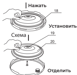
Установка крышки анти-блокировки
