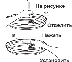
Установка крышки анти-блокировки
